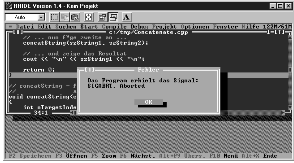
Abbildung 16.4: Ein Einzelschritt auf der ersten Zeile von concatString( ) erzeugt einen Segmentfehler.
