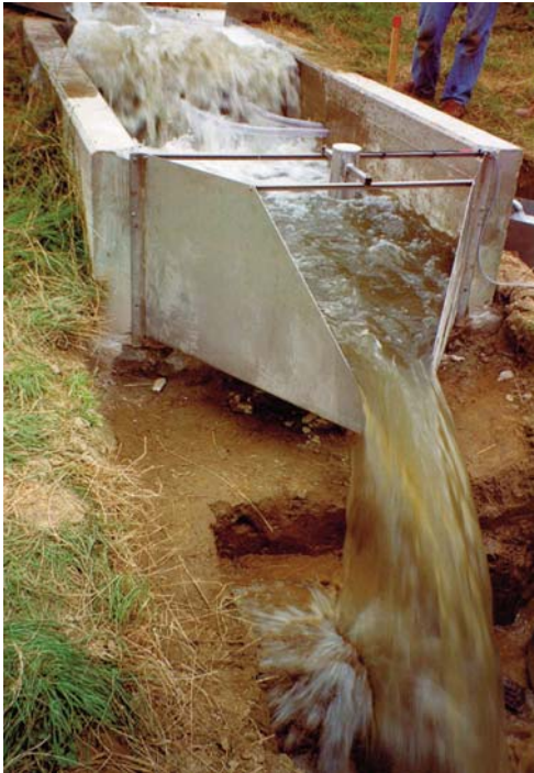
Fig. 56. 2-ft-H-flume near Mettmann/Germany (courtesy Umwelt-Geräte-Technik GmbH Müncheberg).
