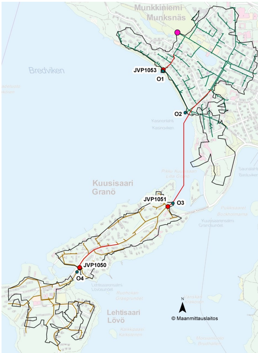
Kuva 18. Munkkiniemen valuma-alue, verkosto, pumppaamot ja ylivuodot.
