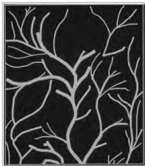
Crystal Morphology Without Pour Point Depressant
