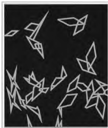
Crystal Morphology With Pour Point Depressant
